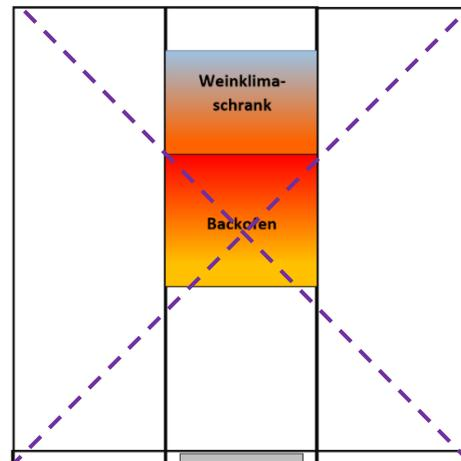
**Keine leistungsfähigen Wärmequellen im Belüftungsbereich vor dem Weinklimaschrank installieren.**
