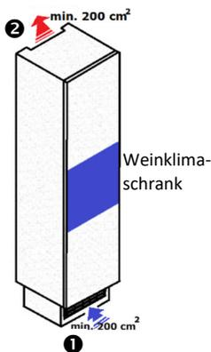
Einbaumodelle im Nischeneinbau brauchen eine ausreichende Belüftung. Dazu wird ein Lufteinlass ① in der Sockelleiste und ein Luftaustritt ② oben an der Rückseite des Küchenmöbels benötigt. Der minimale Lüftungsquerschnitt für beide Aussparungen beträgt 200 cm<sup>2</sup> (z.B. rechteckiger Ausschnitt von 40 mm \* 500 mm)
